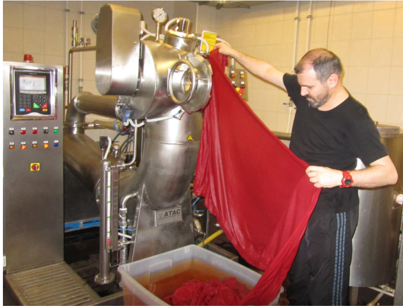
Resim 9: Endüstriyel jet boyama makinesi ile Türk Kırmızısı boyama.
