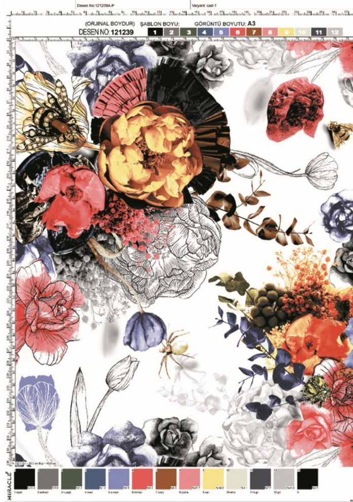
Resim 7. Desenin rotasyon baskı için programda renkleri ve tonları 12 şablona indirilmiş görüntüsü. (Yılmaz, 2022, s.83)
