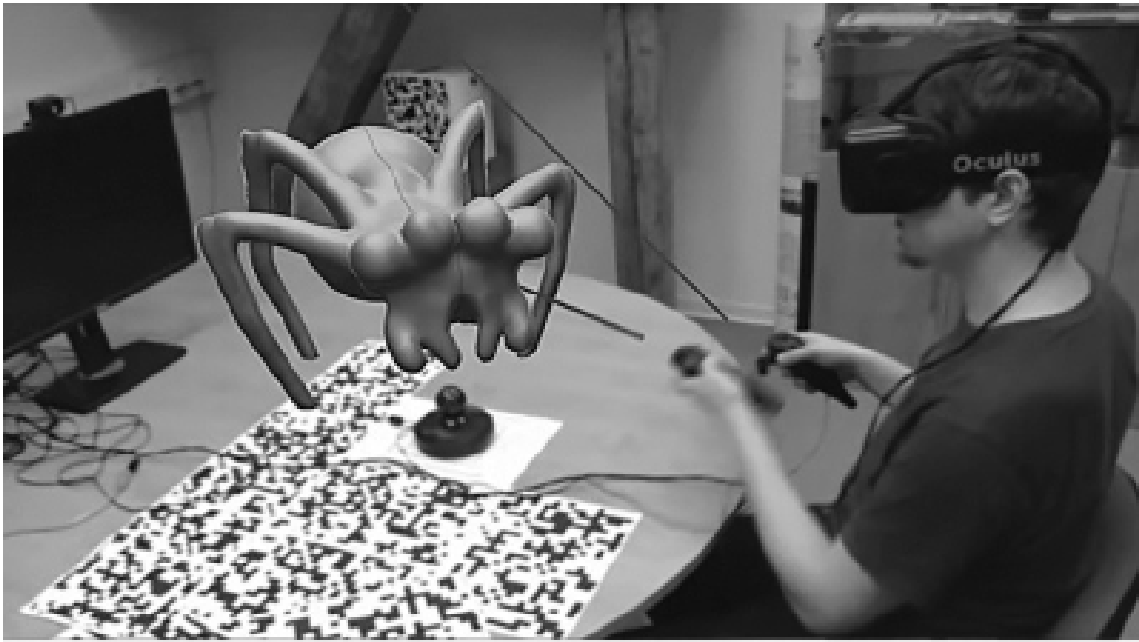
Resim 6. Oculus Rift 3D gözlük ve VRClay yazılımı sayesinde üç boyutlu modellemeyi hızlı ve ulaşılabilir kılan sanal modelleme sistemlerine bir örnek.
