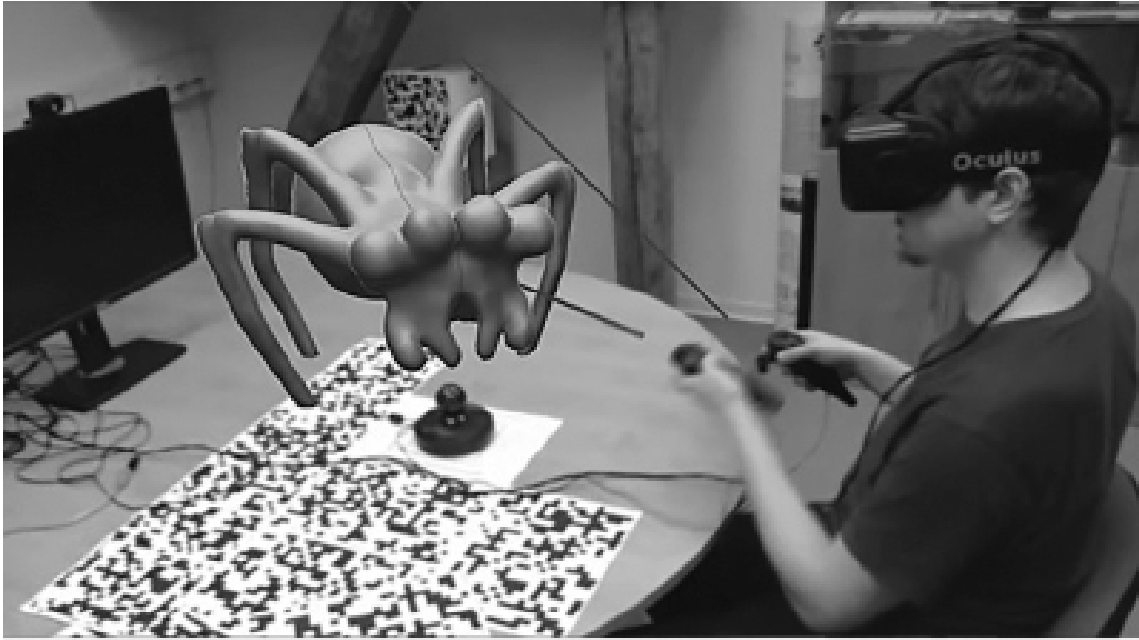
Resim 6. Oculus Rift 3D gözlük ve VRClay yazılımı sayesinde üç boyutlu modellemeyi hızlı ve ulaşılabilir kılan sanal modelleme sistemlerine bir örnek.
